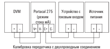
Калибровка передатчика с двухпроводным соединением
